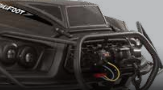
Pare-broussailles avant avec treuil 3,500 lb
