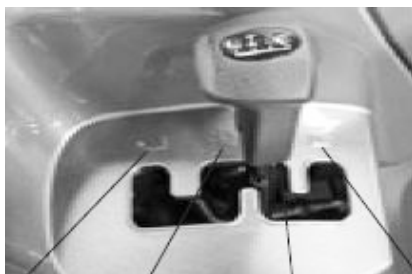
Rapport de vitesse basse Rapport de vitesse élevée Point mort Marche arrière
