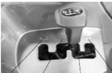
Rapport de vitesse basse Rapport de vitesse élevée Point mort Marche arrière
