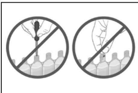
Des bulles se forment au fur et à mesure que le récipient d'électrolyte remplit la batterie pour indiquer l'écoulement de l'acide de batterie. Tapotez de temps en temps le récipient pour maintenir l'écoulement de l'électrolyte jusqu'à ce que le récipient soit complètement vide. Ne percez jamais le dessus du récipient d'acide pour accélérer le processus de remplissage.
