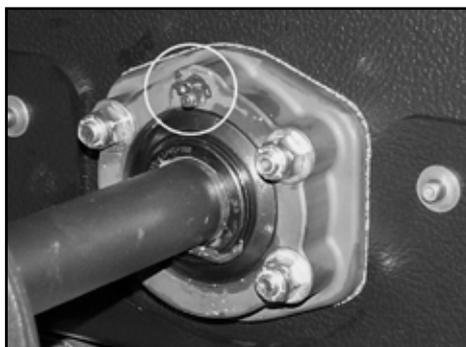
Pour favoriser l'entretien régulier des composants ARGO importants, ARGO a pratiqué un orifice d'accès sur chaque jante et moyeu pour faciliter la lubrification du palier.
