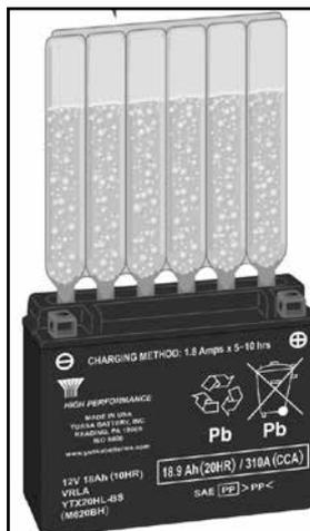
Après le remplissage, les bouchons d'étanchéité doivent être installés en exerçant une pression manuelle uniquement. Le bouchon d'étanchéité ne doit jamais être retiré une fois que la batterie est activée.
