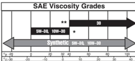
*Les moteurs refroidis par air chauffent plus que les moteurs automobiles. L'utilisation d'huiles multi-viscosité non synthétiques (5W-30, 10W-30, etc.) à des températures supérieures à 40° F (4° C) entraînera une consommation d'huile supérieure à la normale. Lors de l'utilisation d'une huile multi-viscosité, vérifiez le niveau d'huile plus fréquemment.*
