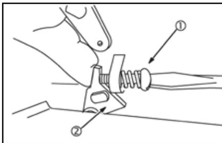
4. À l'aide de l'outil de pliage de tenon (4), pliez le tenon de ralenti réglé (5) jusqu'au ralenti final de 1100 à 1150 tr/min.
