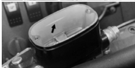
Cylindre de frein hydraulique et niveau de liquide de frein
