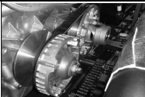
Emplacement des embrayages d'entraînement et de la courroie de transmission
