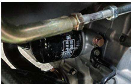
7. Appliquez une mince couche d'huile fraîche sur le joint torique du filtre à huile neuf. Assurez-vous que le joint torique est bien positionné et installez le filtre à huile neuf. Serrez solidement.
