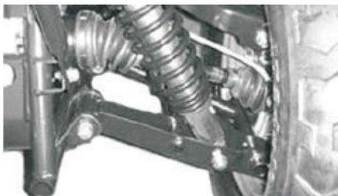
**REMARQUE : Soulevez correctement le VTT au-dessus du sol pour supprimer la charge de la suspension avant de régler les ressorts d'amortisseur. Utilisez une clé tricoise pour régler le manchon de réglage de la raideur des ressorts à la position désirée.**
