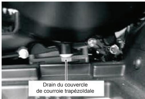
**REMARQUE :** La courroie trapézoïdale et les poulies doivent être inspectées aux 800 km (500 mi), et la courroie remplacée au besoin.
