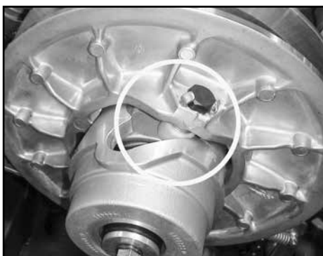
Emplacement des glissières
