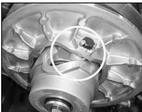
Emplacement des glissières
